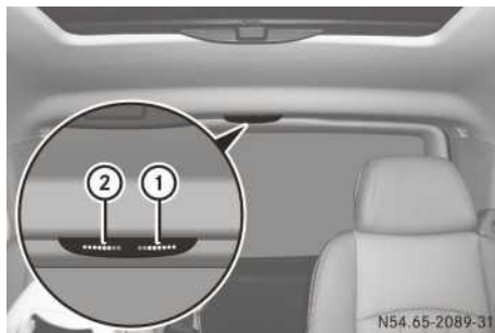
Auton takana olevan alueen varoitusnäyttö kattoverhouskeskellä
