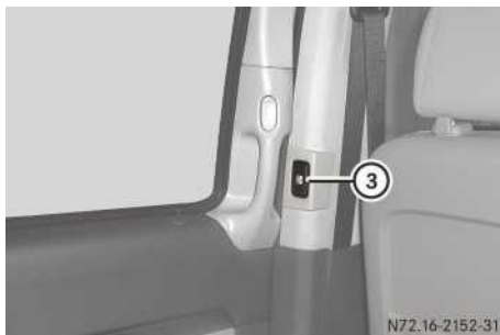
Liukuoven näppäin oviaukossa (B-pilari)
