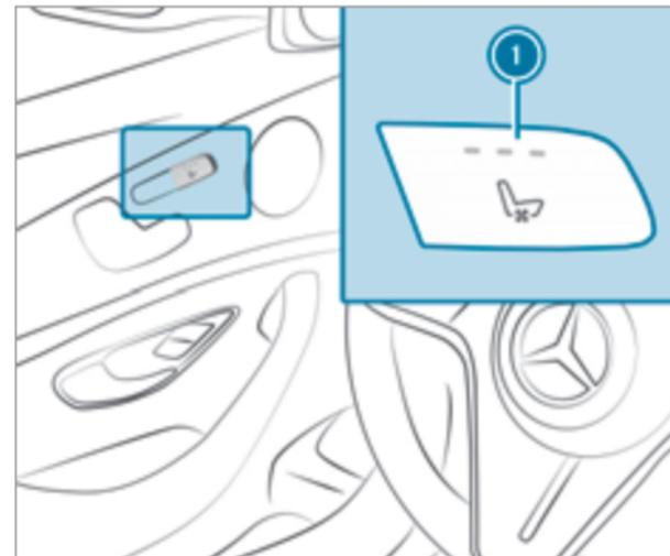
▶ Нажимайте кнопку **i** до тех пор, пока не будет выбран нужный режим работы вентилятора. В зависимости от режима работы вентилятора горит от одной до трех контрольных ламп. Если все контрольные лампы выключены, вентиляция сидений выключена.
