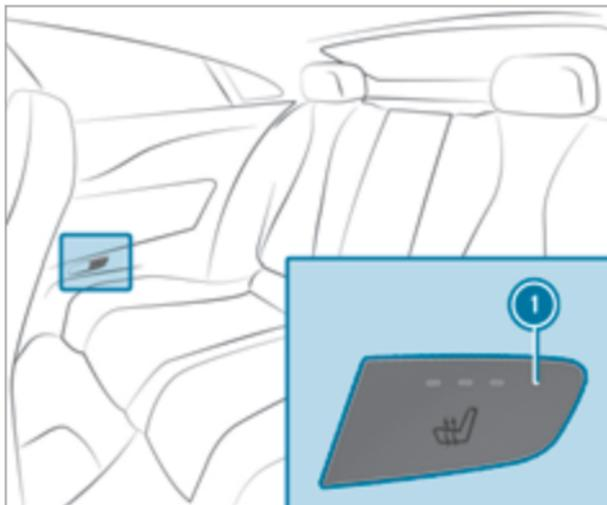
▶ Нажимайте кнопку **i** до тех пор, пока не будет достигнут нужный уровень обогрева. В зависимости от уровня обогрева горит от одной до трех контрольных ламп. Если все контрольные лампы выключены, подогрев сидений выключен.
