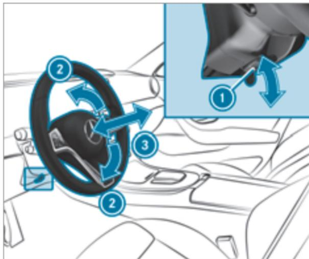
▶ **Разблокировка:** полностью откиньте рычаг разблокировки ① вниз.
