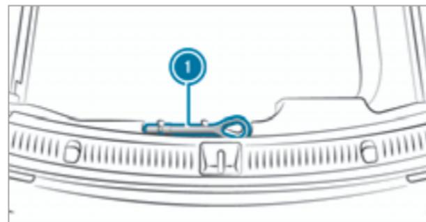
Буксирная проушина ① закреплена под полом багажного отделения на краю багажного отделения.
