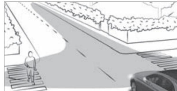
Освещение выполняемого поворота расширяет угол высвечивания дорожного полотна в направлении поворота, таким образом улучшая обзор, например, поворотов малого радиуса. Его активация возможна только при включенном ближнем свете фар.
