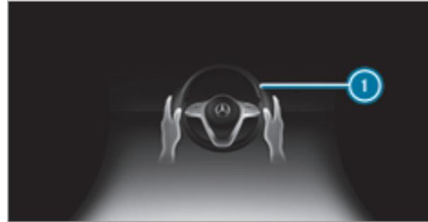
Если система распознает, что водитель относительно долго не осуществляет управление самостоятельно или снимает руки с рулевого колеса, то появляется индикация ❶ на мультифункциональном дисплее. Если водитель и далее не начинает активно управлять автомобилем или не реагирует на срабатывание системы, то дополнительно к оптическому сигналу многократно звучит предупредительный звуковой сигнал.
