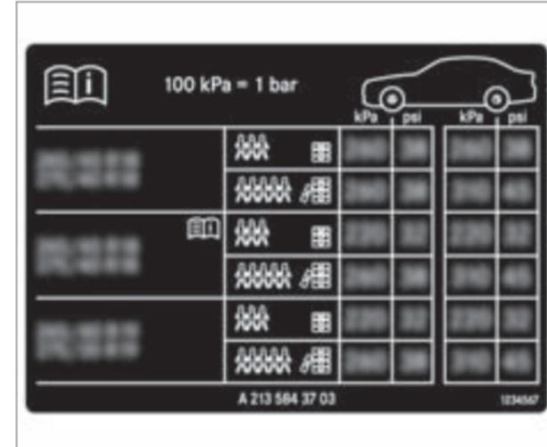
Если перед значениями давления воздуха в шинах указаны один или несколько размеров шин, то следующее за размером шины значение давления воздуха в шинах действительно только для этого размера или этих размеров шин и для соответствующей степени загрузки автомобиля.
