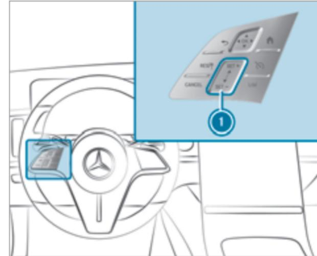
Панель управления на рулевом колесе для системы TEMPOMAT и ограничителя скорости
