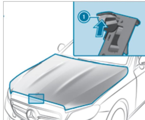
▶ Отожмите ручку ❶ фиксатора капота вверх и приподнимите капот примерно на 40 см.
