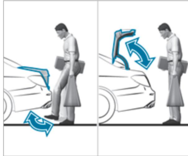
Функция HANDS-FREE ACCESS позволяет открывать и закрывать крышку багажника или останавливать ее путем движения ногой под задним бампером.
