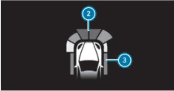
Распознанные системой помощи при парковке PARKTRONIC препятствия опционально отображаются на проекционном дисплее начиная с расстояния примерно 1,0 м спереди ② и 0,7 м по бокам ③.
