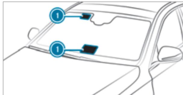
Использующие радиосвязь приборы, например системы учета налогооблагаемого пробега, могут устанавливаться только на пропускающих радиоволны участках ① лобового стекла.
