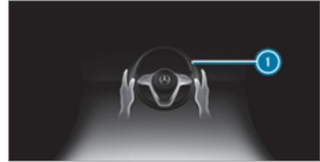
Если система распознает, что водитель относительно долго не осуществляет управление самостоятельно или снимает руки с рулевого колеса, то появляется индикация **1**. Если водитель и далее не начинает активно управлять автомобилем, то дополнительно к оптическому сигналу многократно звучит предупредительный звуковой сигнал.
