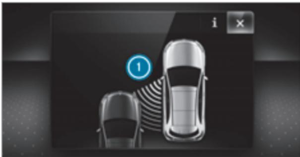
Во время торможения, корректирующего курс движения автомобиля, мигает красная предупредительная сигнальная лампа в наружном зеркале заднего вида и раздается предупредительный звуковой сигнал. Дополнительно на мультимедийном дисплее появляется индикация **i**, обращающая внимание водителя на опасность бокового столкновения.
