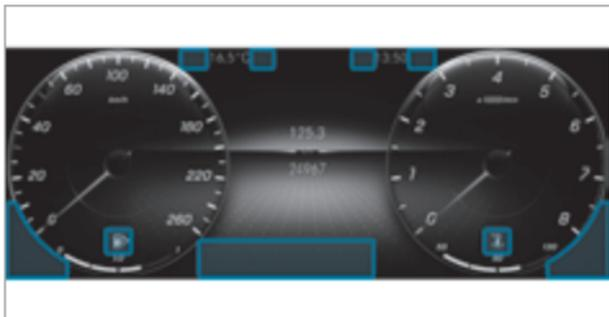
Расположение контрольных ламп на дисплее приборов в зависимости от настроек дисплея может отли-
