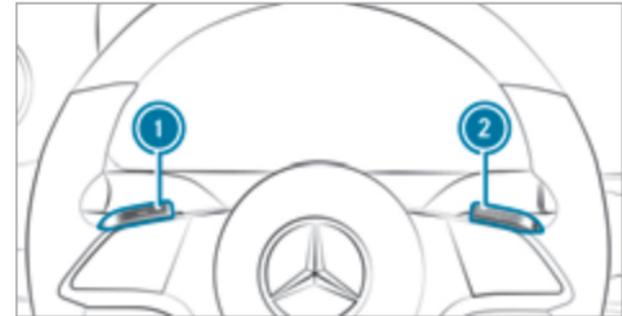
Если автоматическая коробка передач переключена в положение **D**, с помощью подрулевых селекторов АКП можно переключать передачи вручную. Если это допустимо, в зависимости от использованного подрулевого селектора АКП автоматическая коробка передач переключится на более высокую или более низкую передачу.
