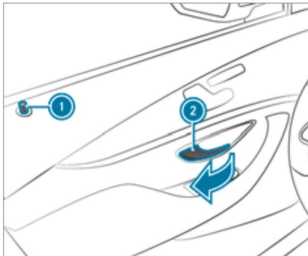
▶ Потяните за ручку двери ②. При разблокировке двери блокирующая кнопка ① выдвигается.
