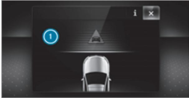
Если происходит автономное торможение или задействуется адаптивная система помощи при торможении, то индицируется сообщение ① на мультимедийном дисплее, и самостоятельно гаснет после непродолжительного времени.
