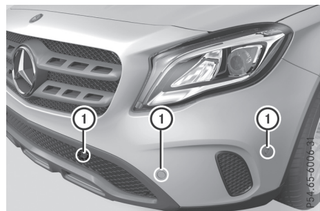
① Датчики на передньому бампері, зліва (приклад)
